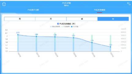
南中心机房PUE值变化
